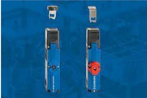
Die Sicherheitszuhaltung AZM150 kann mit drei unterschiedlichen Betätigern für verschiedene Anbausituationen kombiniert werden: ein **gerader Betätiger** für Schiebetüren, ein **gewinkelter Betätiger** für große Drehtüren sowie ein **beweglicher Betätiger** für kleinere Drehtüren.
